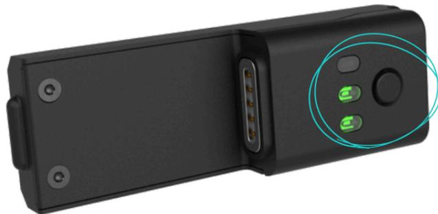
L'état de la batterie est supérieur à 70% lorsque les 3 leds sont allumées, entre 30 et 70% lorsque 2 leds sont allumées et à moins de 30% lorsqu'une seule led est allumée.
