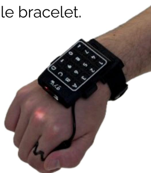
La longueur du scanner est ajustable en fonction de vos préférences. Pour cela, utilisez les encoches prévues à cet effet afin de régler la longueur du câble. Selon la position du ScanPad, le câble doit être positionné à droite ou à gauche. Voir illustration ci-dessous.
